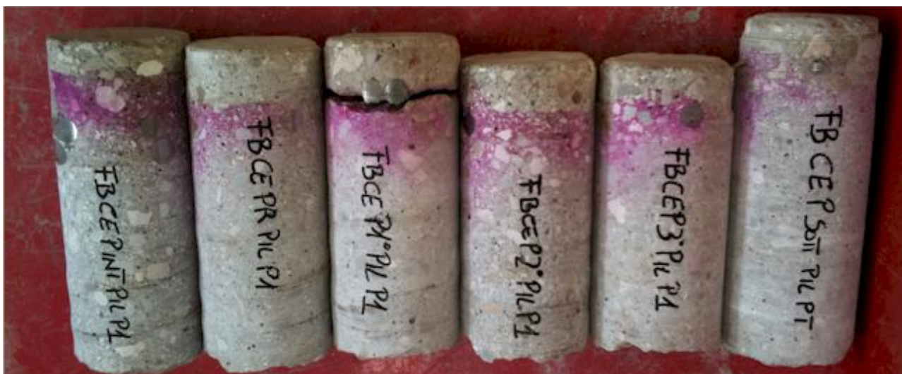
Un esempio di estrazione di carote contenente barre di armatura.
